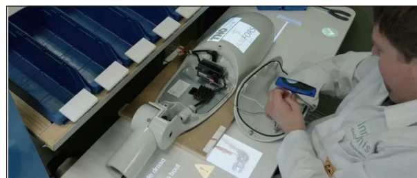
▲ De Smart Beamer stuurt deze werknemer via een stappenplan bij het vervaardigen van een straatlantaarn. © Amfors
